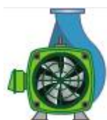
Verde Claro Bomba Ligado em Local (pelo painel elétrico)
