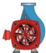
Vermelho Escuro Desligada em "Remoto" Bomba operando Remotamente (pelo Sistema Thor)
