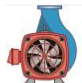
Vermelho Claro Desligada em "Local" Bomba operando localmente (pelo painel elétrico)
